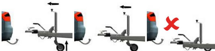
► ¡Girar la manivela de la rueda de apoyo automática sólo en estado acoplado!
