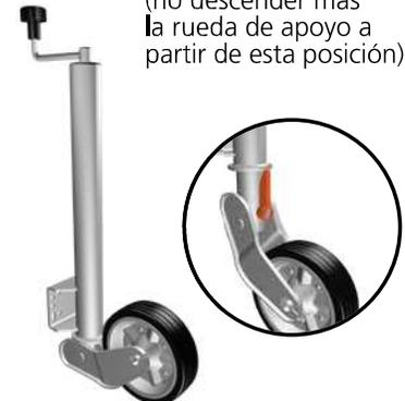
Rueda de apoyo automática (ajuste aproximado mediante el mecanismo de cierre y el accionamiento de husillo)
