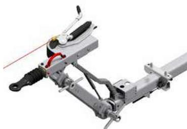
El ángulo entre la lanza de tracción y la pieza intermedia se puede ajustar entre  $-10^\circ$  hasta  $+49^\circ$ . Los dentados frontales se unen entre sí mediante un perno roscado y una tuerca de regulación. Entre la lanza de tracción y el dispositivo de retención se puede incorporar opcionalmente un dispositivo de elevación y reajuste. Un resorte a gas integrado genera una fuerza de empuje independiente que reduce claramente la fuerza necesaria para el accionamiento.
