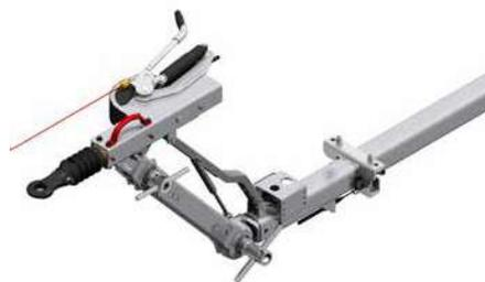
Lanza de tracción regulable en altura
